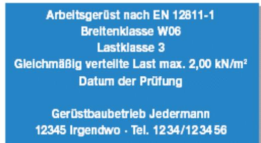
Beispiel einer Kennzeichnung eines fertig gestellten Arbeitsgerüsts.
