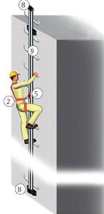
Auffangsystem mit mitlaufendem Auffanggerät einschließlich beweglicher Führung
